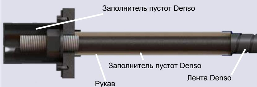
Процесс намотки ленты проходит быстро и эффективно на заводе компании Macalloy с помощью уникального оборудования Denso Tare. Преимущества использования коррозионной защиты системы Macalloy заключаются в следующем:
