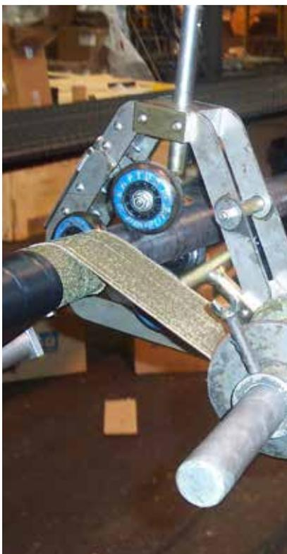
это обвертывание стержня защитным барьером, содержащим поглотители кислорода, например, продукты марки Denso. См. Таблицу 7.
