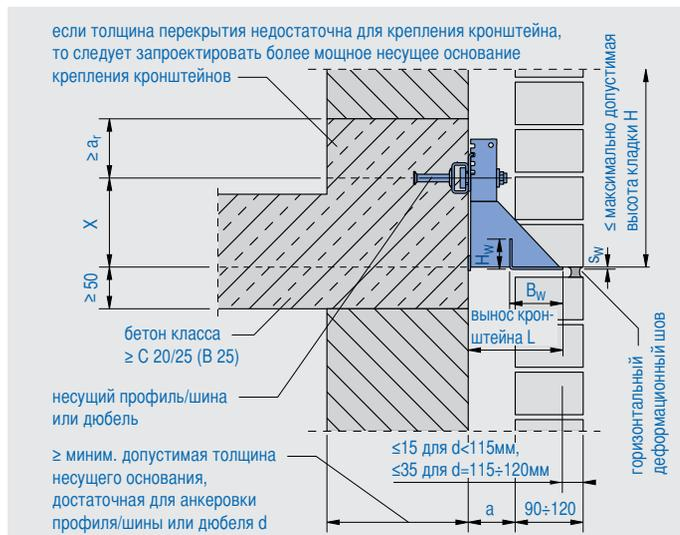
Крепление облицовки с помощью кронштейна JVA+F. Ситуация в разрезе
